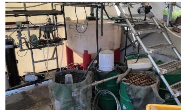
精製濾過設備、ペール缶洗浄設備完成 濾過実験検証実施
