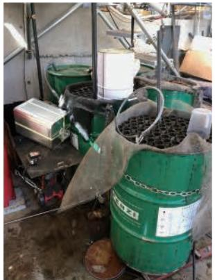
廃食油精製拠点の整備を進め、実証用精製プラントが完成した。現状のシステムでは 0.5 トン / 日の精製が可能。
